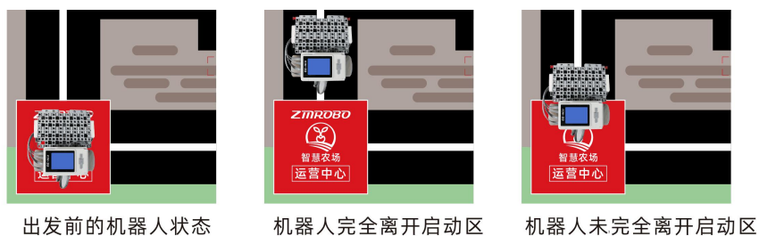
图 2 机器人屏幕显示蓝色及在启动区的几种状态
